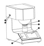
①测量孔 ②试样托 ③触摸屏 ④打印机 ⑤荧光调节螺钉 ⑥拉板
